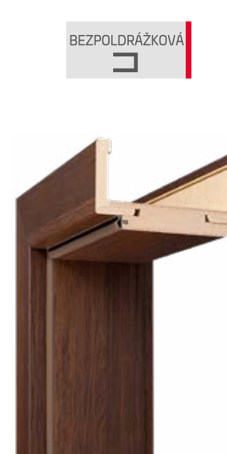
Zárubňa obložková z MDF s rovnakým dekorom ako na dvernom krídle 600 – 900/1983/135 – 155 mm
